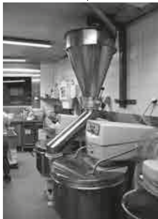
Das Mehl kommt über Rohre direkt in die Dosieranlage.
