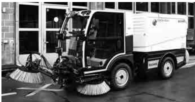
Die neue Kehmaschine mit 3 Bürsten und Knicklenkung ist bereit für die Übergabe.
