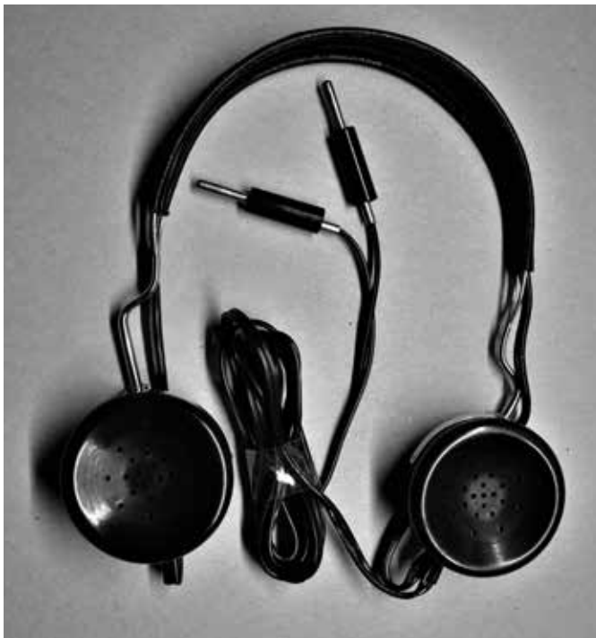
Der Kopfhörer mit 2x2000 Ohm.
