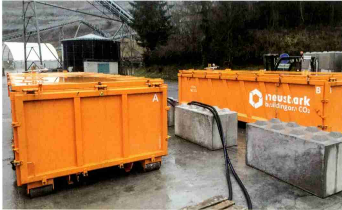
Die mit Betongranulat gefüllten Reaktorcontainer werden an das CO 2 -Gassystem von neustark angeschlossen.
