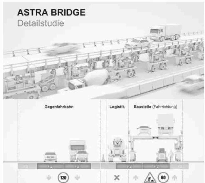
In seinem Video erklärt das Astra, wie die «Astra Bridge» funktioniert: Es handelt sich um eine mobile, befahrbare Brücke für Autobahn-Bau- stellen, über die der Verkehr geführt wird, während unter der Brücke Bauarbeiten ausgeführt werden. Bild: Astra/YouTube
