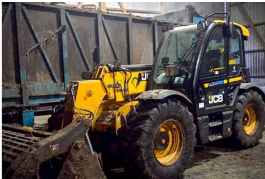
Der Teleskopplader JCB 536-95 erreicht eine maximale Hubhöhe von 9,5 m. Bild: Yannick Berger
