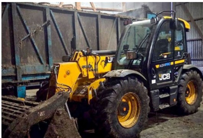
Le télescopique JCB 536-95 permet une hauteur de levage atteignant 9,5 m. Photo: Yannick Berger
